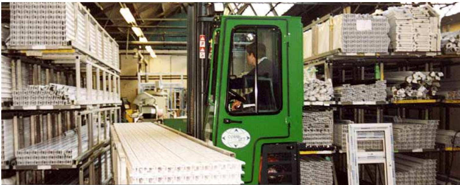
Xe nâng hàng có tải dài dùng cho lối đi hẹp 3-trong-1: Forklift - Sideloader - Aisle Truck Long Loads, Narrow Aisle, 3-in-1: Forklift - Sideloader - Aisle Truck Ga - Dầu - Điện LPG - Diesel - Electric
