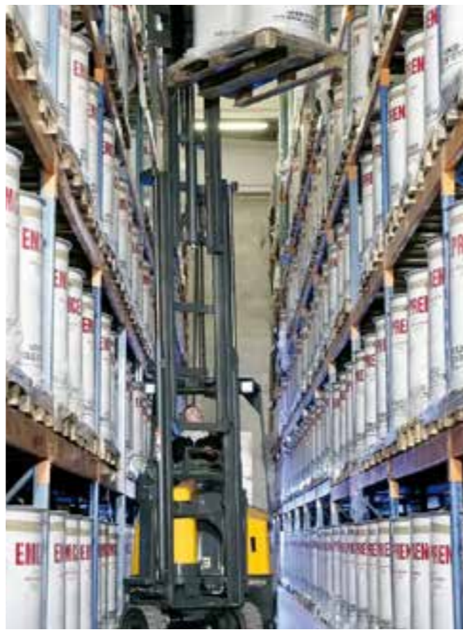
Xe Aisle Master Aisle Master Forklift Truck Độ rộng lối đi: 1.8 m Chiều cao nâng: lên đến 15 m Aisle Width: 1.8 m Lifting Height: up to 15 m
