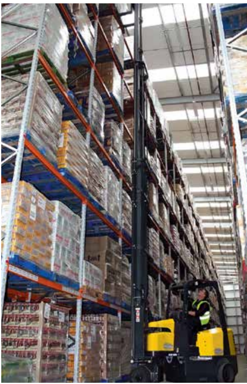
Xe Aisle Master Aisle Master Forklift Truck Độ rộng lối đi: 1.8 m Chiều cao nâng: lên đến 15 m Aisle Width: 1.8 m Lifting Height: up to 15 m
